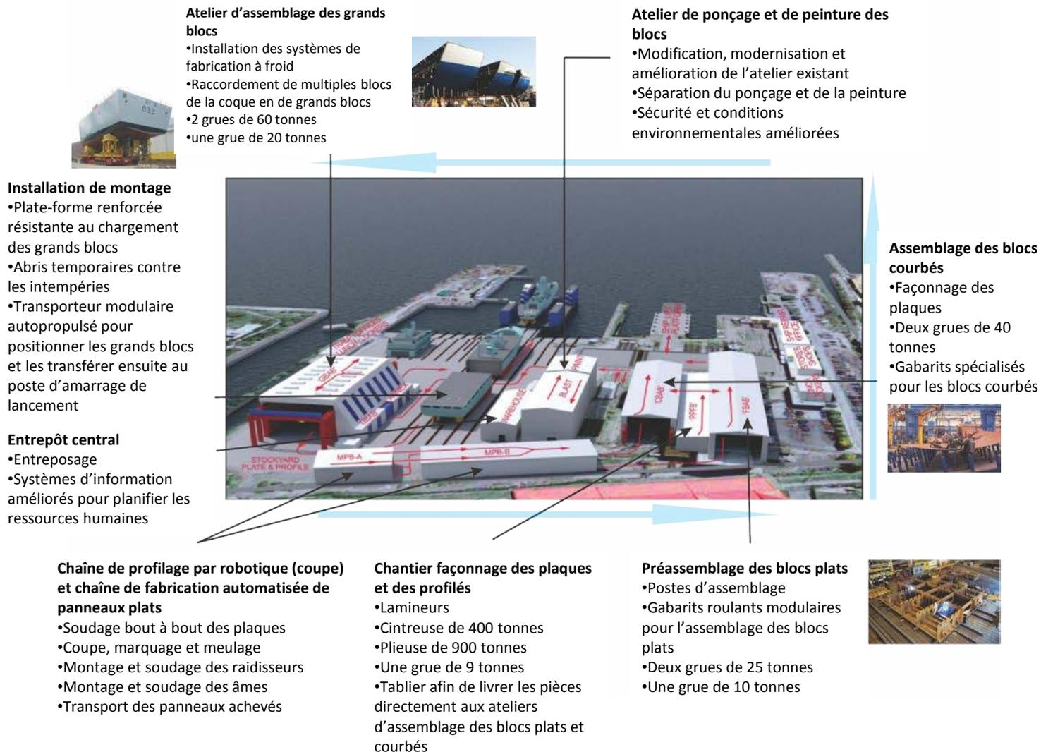
**Figure 11-6 : Améliorations prévues au chantier naval de Victoria**
